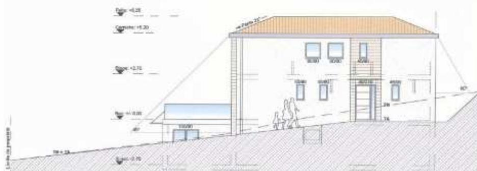
Le plan de coupe représente la construction vue à l'intérieur. Il en existe de deux sortes: **Les coupes verticale et horizontale.** Il permet de donner des renseignements techniques précis sur le bâtiment, il peut y en avoir un grand nombre: Le nombre d'étage et différentes pièces de la construction .
