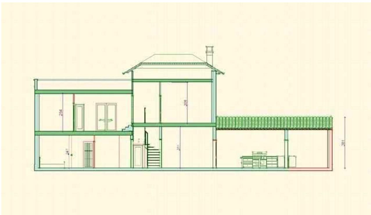
Le plan de coupe représente la construction vue à l'intérieur. Il en existe de deux sortes:
